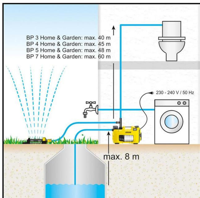
1. Podłączyć wąż ssący i przewód ciśnieniowy (patrz rozdział *Zastosowanie mobilne*). W instalacji stałej nie należy stosować szybkozłącz, lecz połączenia śrubowe.
